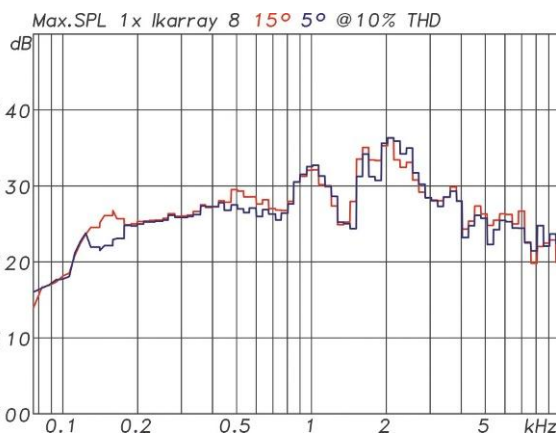
Maximalpegel für höchstens 10% Verzerrungen für ein einzelnes Ikarray-8 System mit 15° (rot) Öffnungswinkel und mit 5° (blau) Öffnungswinkel. Die Messung erfolgte mit 185 ms langen Sinusbursts (Abb. 16)
