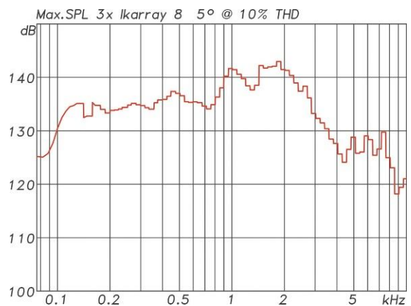
Maximalpegel für höchstens 10% Verzerrungen für ein Array aus drei Systemen mit 5° Öffnungswinkel. Die Messung erfolgte mit 185 ms langen Sinusbursts (Abb. 17)
